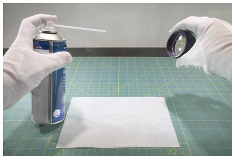
Abb. 7-1 Reinigung mit Druckluft
