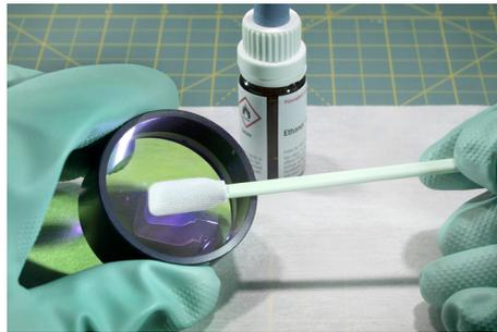
Abb. 7-2 Reinigung mit Pads
